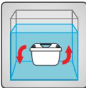
Vložku vložte na 15 minút do nádoby so studenou pitnou vodou. Potom ešte raz filtračnou vložkou potraste, aby ste odstránili všetky vzduchové bublinky.
