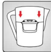
Reinigen Sie die Kartusche und platzieren Sie diese in der Filterhalterung der Kanne.
