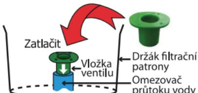
Vložte přiloženou ZELENOU VLOŽKU VENTILU
