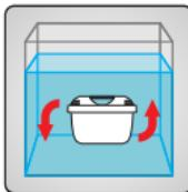
Legen Sie die Kartusche in einen Behälter mit kaltem Leitungswasser für 15 Minuten. Dann schütteln Sie den Filter wieder, um eventuelle Lufteinschlüsse zu entfernen.
