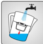
Introduza água da torneira fria na secção superior do jarro filtrante. Deixe depois a água atravessar o filtro.
