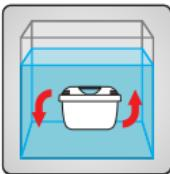
Coloque o cartucho num recipiente com água da torneira fria durante 15 minutos. De seguida, agite o filtro novamente para remover eventuais bolhas de ar.
