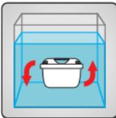
Włóż wkład do pojemnika z zimną wodą z kranu na 15 minut. Następnie jeszcze raz potrząsnij wkładem filtra, aby pozbyć się pęcherzyków powietrza.
